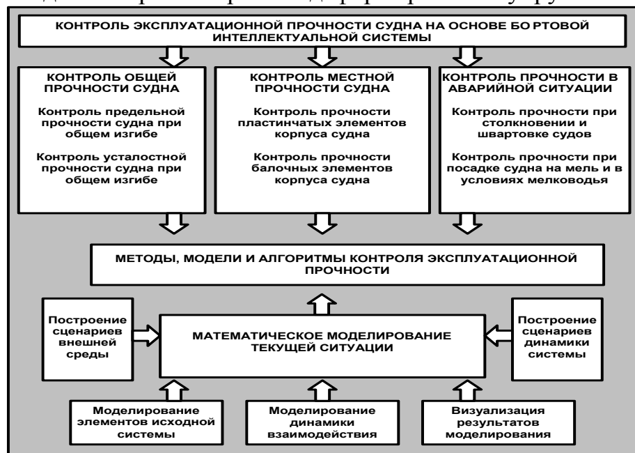
Рисунок 1 – Концептуальная модель интегрированного вычислительного комплекса контроля эксплуатационной прочности судна
