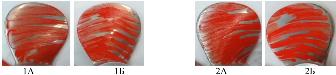
Рисунок 3 – Линии тока на лопасти модели ледового гребного винта: без применения шероховатости входящей кромки (1А – засасывающая, 1Б – нагнетающая сторона); шероховатость 30 мкм, длина области 2.5 % (2А – засасывающая, 2Б – нагнетающая сторона)
